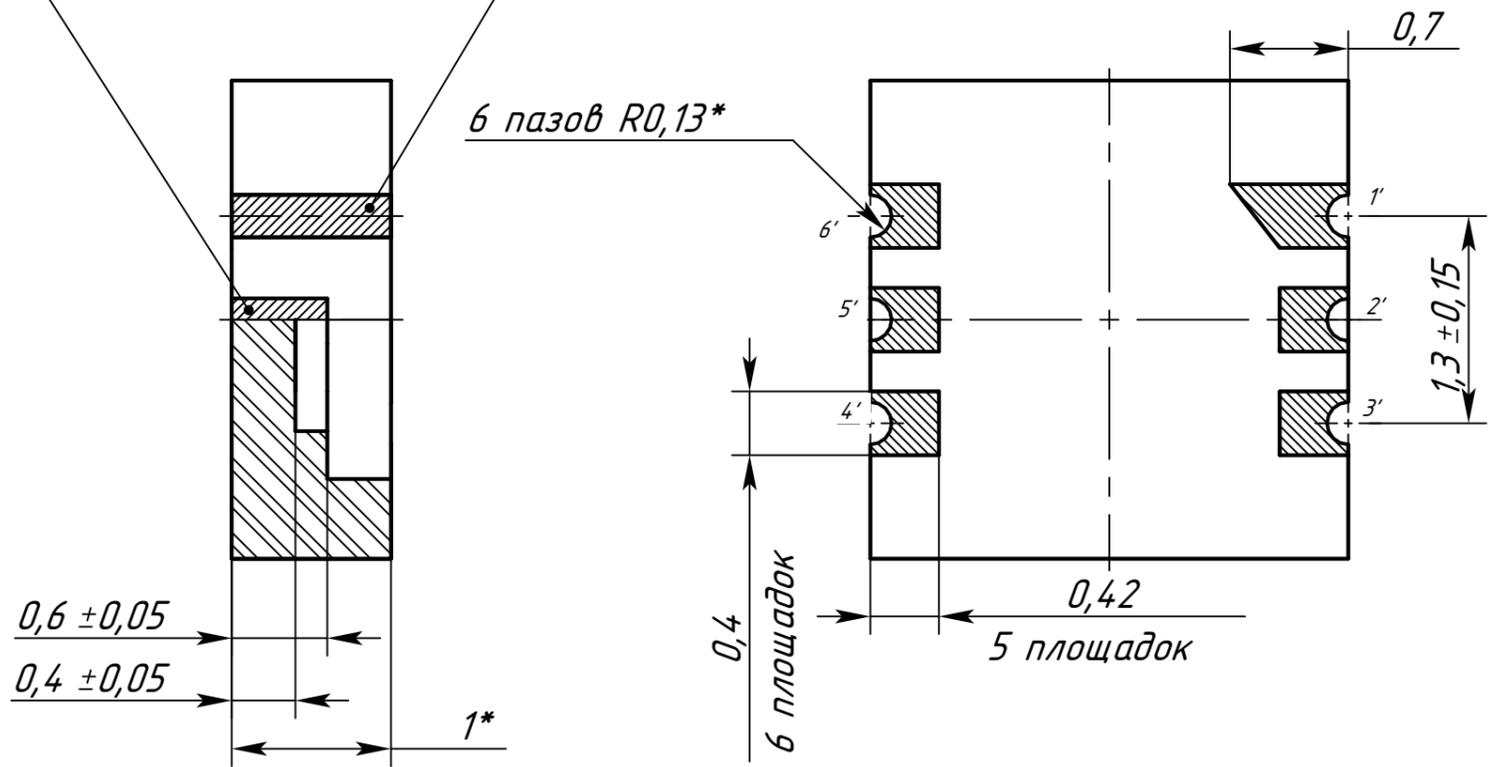
1. Покрытие Хим.Н1, ЭлЗ.  $F_{эл} = 10,86 \text{ мм}^2$ .
